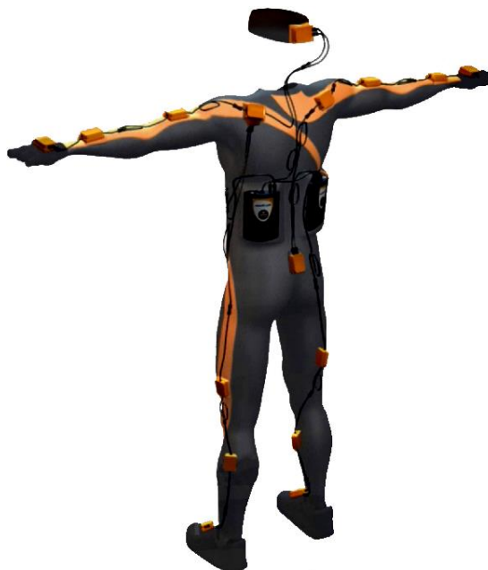
Slika 2. Prikaz odijela i senzora sustava Xsens. (preuzeto sa:
